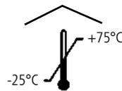
Umgebungstemperatur für Transport und Lagerung. Ein Transport und die Lagerung außerhalb der vorgegebenen Temperaturbereiche können zur Schädigung des Gerätes und damit zur Gefährdung des Patienten, Anwenders oder Dritter führen.
