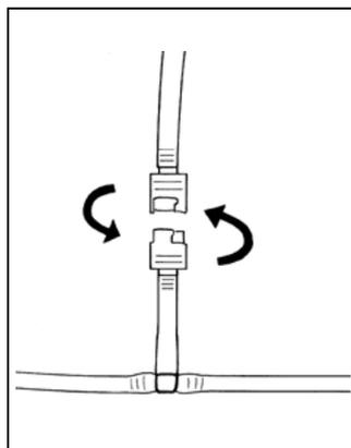
Beim Herausnehmen der Erweiterung diese an der Schlauchkupplung lösen.
